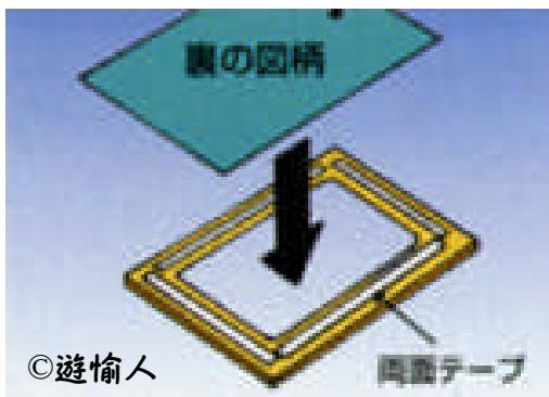
枠の片面に両面テープを貼り、台などの上に広げたフィルムに押し付けます。
