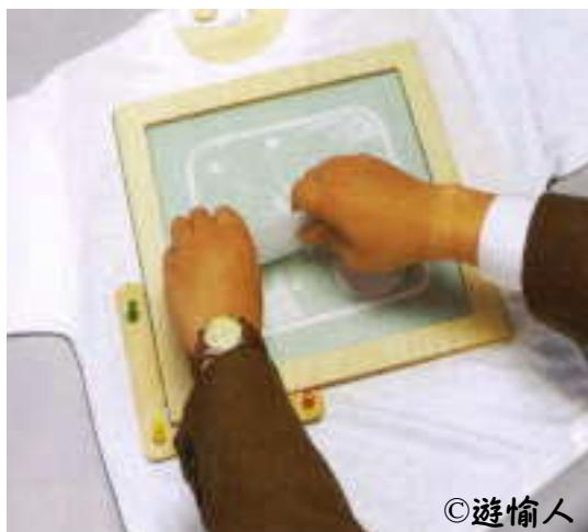
シルクスクリーンスタートキットをお買い上げの方は、パネルハンガーを使って、版をTシャツなどの印刷したい素材に固定します。
