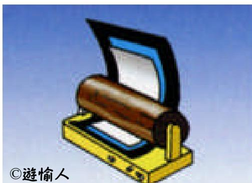
露光器を開けて下からホルダー（黒）、シルクスクリーンフィルム、原稿の順に重ねて巻き、しっかりと止めます。
